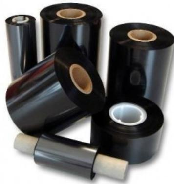
**Термо-трансферная печать** позволяет получить более долговечные этикетки на обычной бумаге. В принтер заряжается рулон этикеток и рулон термотрансферной пленки. Ролики прижимают друг к другу ленты из этих рулонов и подают на печатающую термоголовку. под воздействием температуры красящее вещество с термотрансферной ленты переходит на этикетку, где и остается на длительное время.
