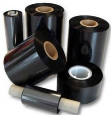
**Термо-трансферная печать** позволяет получить более долговечные этикетки на обычной бумаге. В принтер заряжается рулон этикеток и рулон термотрансферной пленки. Ролики прижимают друг к другу ленты из этих рулона и подают на печатающую термоголовку. Под воздействием температуры красящее вещество с термотрансферной ленты переходит на этикетку, где и остается на длительное время.
