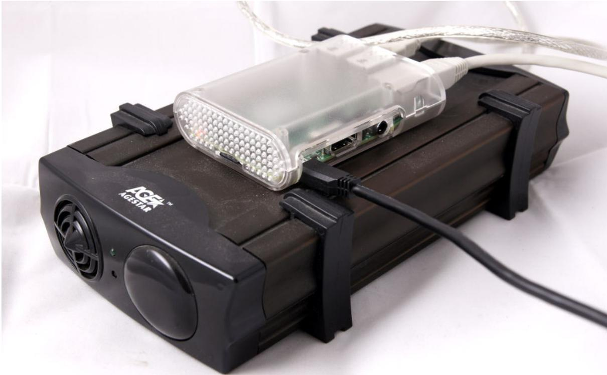
Примерно в такую цену Вам обойдется микрокомпьютер Raspberry Pi, пластиковый корпус для него, microSD карта и блок питания (внешний жесткий диск, будем считать, у Вас уже есть). Этот микрокомпьютер работает под управлением Linux-based операционной системы Raspbian, как сделать на нем собственное NAS хранилище, читайте в статье [Организация файлового хранилища на Linux](#).
