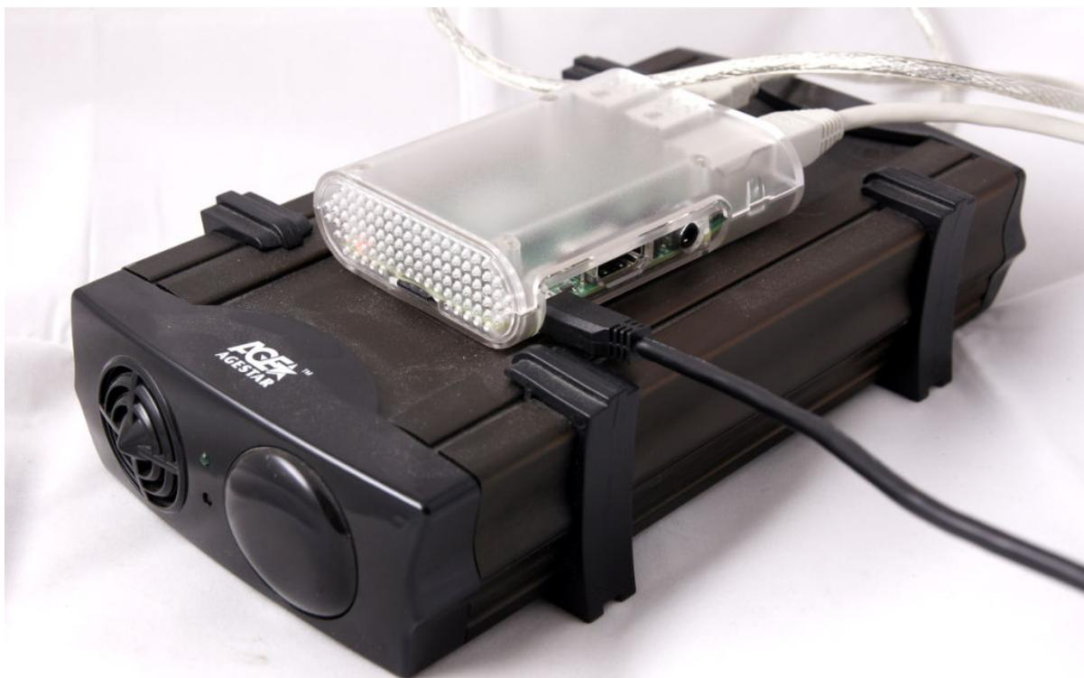
Примерно в такую цену Вам обойдется микрокомпьютер Raspberry Pi, пластиковый корпус для него, microSD карта и блок питания (внешний жесткий диск, будем считать, у Вас уже есть). Этот микрокомпьютер работает под управлением Linux-based операционной системы Raspbian, как сделать на нем собственное NAS хранилище, читайте в статье [Организация файлового хранилища на Linux](#).
